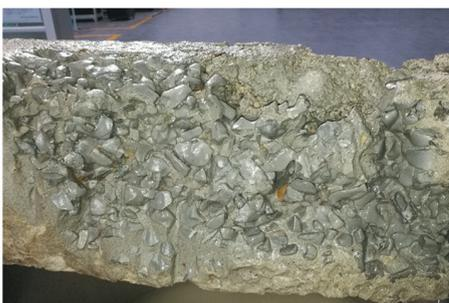
图 6 扇形磨料水射流冲蚀后废弃混凝土形貌
