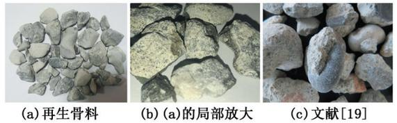
图 7 再生骨料外观形貌对比
