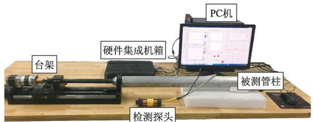
图9 试验测试系统
