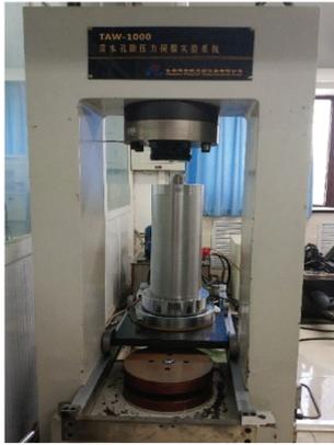
图4 深水孔隙压力伺服实验系统 TAW-1000
