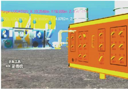
图7 水下采油树维修时 ROV 操作控制面板(系统截图)
