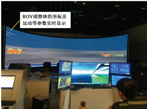
图8 海底管道泄漏法兰连接修复时吊机与 ROV 协同操作
