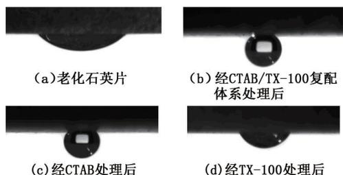
图 4 经不同表面活性剂体系处理后老化石英片表面的润湿性变化
