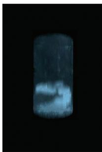
图 8 2 mL/min 驱替后岩心 MRI 三维合成图截图
