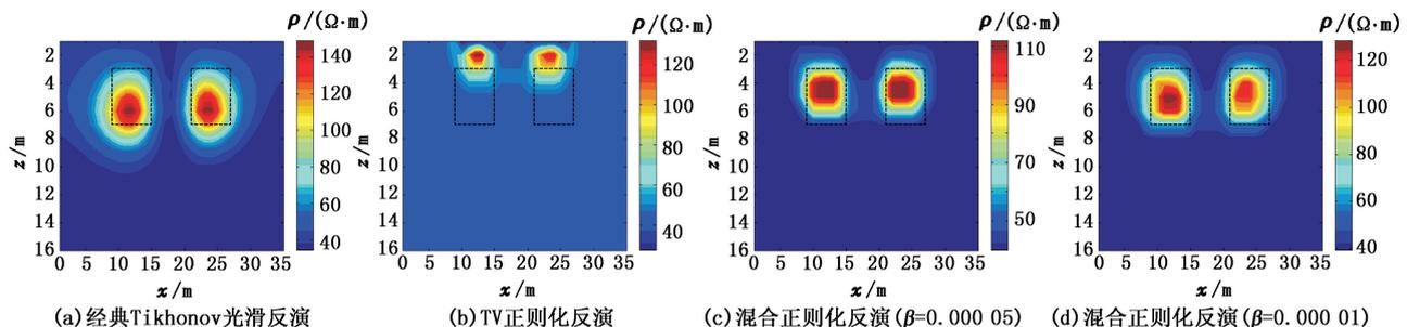
图4 模型1反演结果垂直剖面图( $y=17\text{ m}$ )
