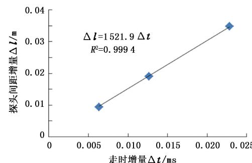
图3 蒸馏水( $26^\circ\text{C}$ 、 $20 \text{ MPa}$ )探头间距增量与走时增量交会图
