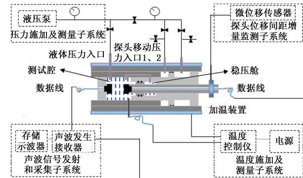
图 2 “免”刻度的高温高压液体声速透射法实验测量装置示意图
