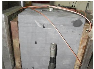
图1 声发射探头的布置
