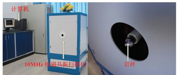
图 1 SPEC-23 核磁共振测试装置
